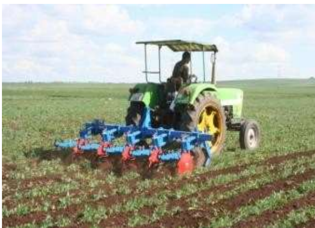
Photo 10: Sarclage mécanique du petit pois
