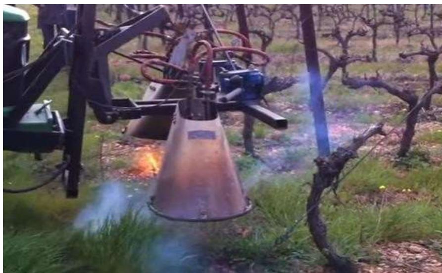
Photo 6: Désherbage thermique d'un vignoble (Humeau, 2022).
