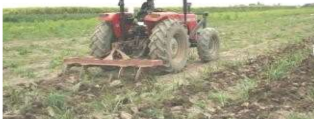
Photo 6: Sarclage mécanique entre les lignes de la canne vierge.
