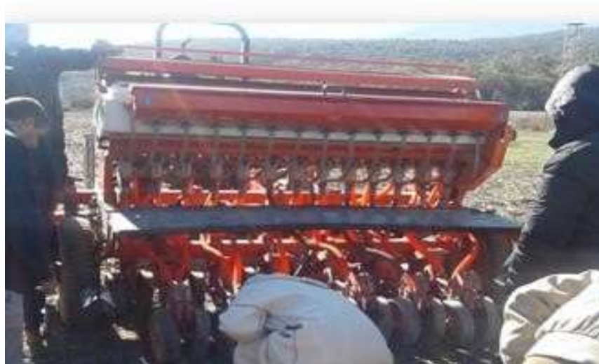
Photo 1: Semoir de semis direct à traction mécanique (Photo. Hajjaj B.).
